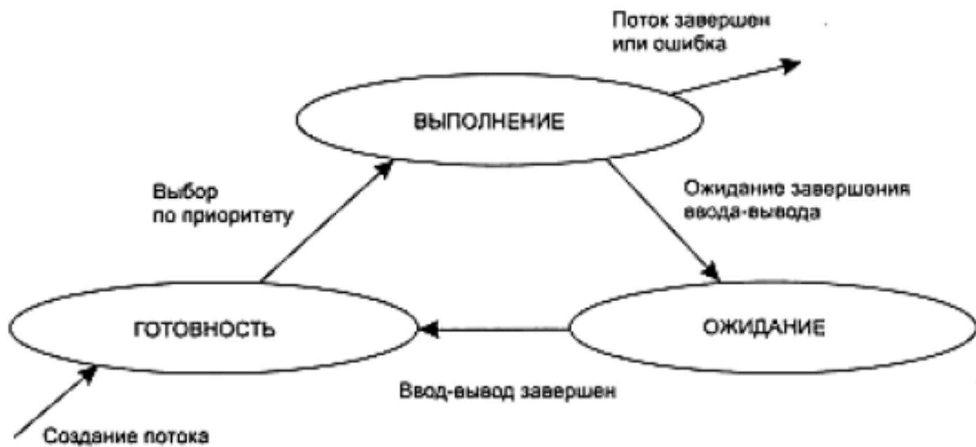
Рисунок 3.8 – Граф состояний потока в системе с относительными приоритетами
