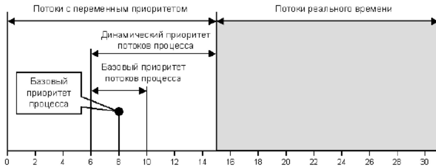
Рисунок 3.7 – Схема назначения приоритетов в Windows NT
